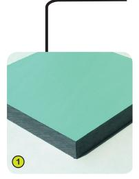
1- Les plaques colorées sont élaborées à partir d'un matériau compact d'une épaisseur de 13 mm. Composé de 70 % de fibres de bois tendre et de 30 % de résine thermodurcissable, celui-ci présente une excellente résistance aux intempéries (soleil, pluie, humidité...).
