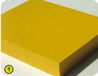
1- **Les plaques laquées** sont élaborées à partir d'un contreplaqué de 22 mm de très haute qualité composé de plis minces en bouleau. La mise en couleur est réalisée par pulvérisation de laque polyuréthane sans plomb en 3 couches dont une couche de finition vernie. Les chants sont protégés par plusieurs couches d'apprêt polyuréthane souple.
