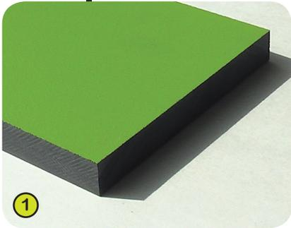
1- **Les plaques colorées** sont élaborées à partir d'un matériau compact d'une épaisseur de 13 mm. Composé de 70% de fibre de bois tendre et de 30% de résine thermodurcissable, celui-ci présente une excellente résistance aux intempéries. Les faces colorées sont traitées à base de résines acryliques polyuréthanes pigmentées, ce qui assure une bonne tenue aux ultraviolets et aux dégradations.
