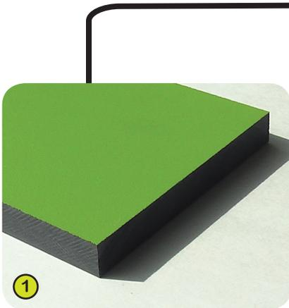
1- **Les plaques colorées** sont élaborées à partir d'un matériau compact d'une épaisseur de 13 mm. Composé de 70% de fibre de bois tendre et de 30% de résine thermodurcissable, celui-ci présente une excellente résistance aux intempéries. Les faces colorées sont traitées à base de résines acryliques polyuréthanes pigmentées, ce qui assure une bonne tenue aux ultraviolets et aux dégradations.
