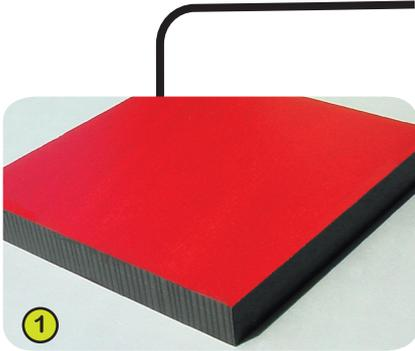
1- **Les plaques colorées** sont élaborées à partir d'un matériau compact (HPL) d'une épaisseur de 13 mm. Matériau robuste, il présente une excellente résistance aux intempéries et au vandalisme.
