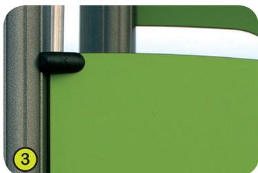
3- **Les palissades et les toits** sont composés de plaques colorées élaborées à partir d'un matériau compact d'une épaisseur de 13 mm. Composé de 70% de fibre de bois tendre et de 30% de résine thermodurcissable, celui-ci présente une excellente résistance aux intempéries. Les faces colorées sont traitées à base de résines acryliques polyuréthanes pigmentées, ce qui assure une bonne tenue aux ultraviolets et aux dégradations.
