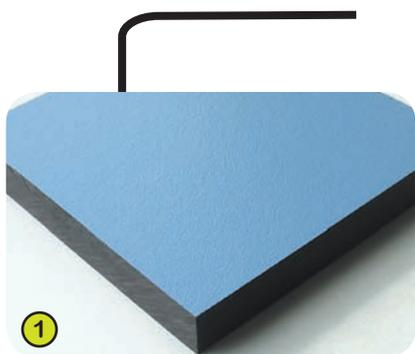
1- **Les plaques colorées** sont élaborées à partir d'un matériau compact d'une épaisseur de 13 mm. Composé de 70 % de fibres de bois tendre et de 30 % de résine thermodurcissable, celui-ci présente une excellente résistance aux intempéries (soleil, pluie, humidité...).
