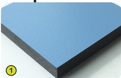
1- **Les plaques colorées** sont élaborées à partir d'un matériau compact d'une épaisseur de 13 mm. Composé de 70 % de fibres de bois tendre et de 30 % de résine thermodurcissable, celui-ci présente une excellente résistance aux intempéries (soleil, pluie, humidité...). Les faces colorées sont traitées à base de résines acryliques polyuréthanes pigmentées, ce qui lui assure une bonne tenue aux UV et aux dégradations.
