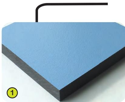
1- **Les plaques colorées** sont élaborées à partir d'un matériau compact d'une épaisseur de 13 mm. Composé de 70 % de fibres de bois tendre et de 30 % de résine thermodurcissable, celui-ci présente une excellente résistance aux intempéries (soleil, pluie, humidité...). Les faces colorées sont traitées à base de résines acryliques polyuréthanes pigmentées, ce qui lui assure une bonne tenue aux UV et aux dégradations.
