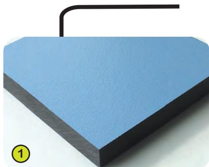
1- **Les plaques colorées** sont élaborées à partir d'un matériau compact d'une épaisseur de 13 mm. Composé de 70 % de fibres de bois tendre et de 30 % de résine thermodurcissable, celui-ci présente une excellente résistance aux intempéries (soleil, pluie, humidité...).
