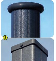
**2- Les poteaux,** diamètre 125 mm, et **les poteaux centraux**, 95 x 95 mm, sont en acier galvanisé laqué. La finition granitée en deux tons de gris présente de légers reliefs et confère une meilleure résistance aux rayures.
