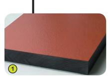
1- Les plaques colorées sont élaborées à partir d'un matériau compact d'une épaisseur de 13 mm. Composé de 70 % de fibres de bois tendre et de 30 % de résine thermodurcissable, celui-ci présente une excellente résistance aux intempéries (soleil, pluie, humidité...).
