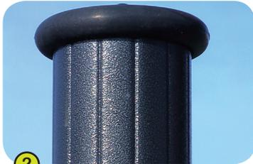
2- **Les poteaux**, diamètre 125 mm, et **les poteaux centraux**, 95 x 95 mm, sont en acier galvanisé laqué. La finition granitée en deux tons de gris présente de légers reliefs et confère une meilleure résistance aux rayures. Les poteaux ronds sont recouverts d'un chapeau en polyamide injecté. Les poteaux carrés sont recouverts d'un chapeau en polyamide chargé.
