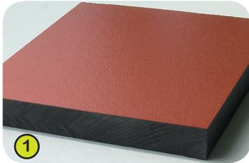
1- **Les plaques colorées** sont élaborées à partir d'un matériau compact d'une épaisseur de 13 mm. Composé de 70 % de fibres de bois tendre et de 30 % de résine thermodurcissable, celui-ci présente une excellente résistance aux intempéries (soleil, pluie, humidité...). Les faces colorées sont traitées à base de résines acryliques polyuréthanes pigmentées, ce qui lui assure une bonne tenue aux UV et aux dégradations.
