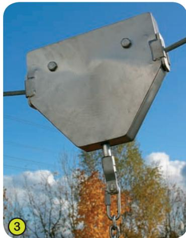
3- **Le chariot du téléphérique** est en inox pour garantir sa longévité. Ses roulettes sont en polyamide, minimisant ainsi le bruit lors du mouvement. Le mécanisme de blocage à vide du chariot lui permet de garder automatiquement sa position lorsqu'aucune force n'est appliquée.
