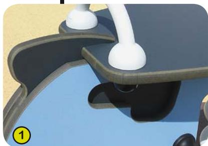
1- **Les plaques colorées et les sièges** sont élaborés à partir d'un matériau compact (HPL) d'une épaisseur de 13 mm. Matériau robuste, il présente une excellente résistance aux intempéries et au vandalisme.
