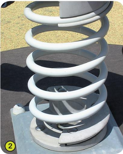
2- **Le ressort** est en acier 35SCD6. Sa surface est traitée après grenailage de pré-contrainte puis recouverte de l'apprêt zinc et de 2 couches de poudre époxy polyester de 100 microns. La pièce de maintien (Brevet Proludic), en polyamide chargé, assure une longévité et une sécurité exceptionnelle au système.
