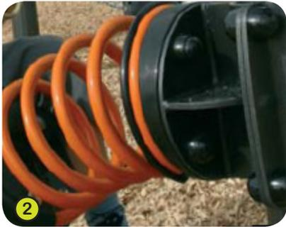
2- **Le ressort** est en acier 35SCD6. Sa surface est traitée après grenailage de précontrainte puis recouverte de l'apprêt zinc et de 2 couches de poudre époxy polyester de 100 microns. La pièce de maintien (Brevet Proludic), en polyamide chargé, assure une longévité et une sécurité exceptionnelle au système.
