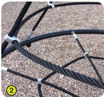
2- **Le cordage Polyfix**, Ø 16 mm, est composé de 6 câbles d'acier galvanisé de 0,8 mm entourés de polypropylène multifilaments. L'âme est en polypropylène 6 x 0,7 x 0,8 mm.
